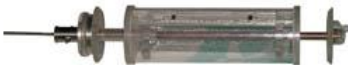
Рис. 6.1. Батометр класичний БРМ – батометр Руттнера
