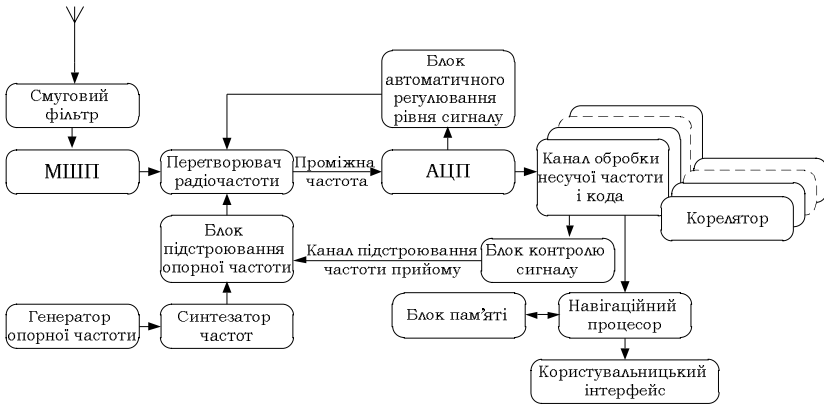
Рис. 3.12. Узагальнена структурна схема навігаційних приймачів
