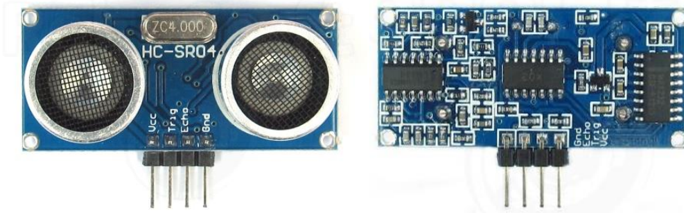
Рисунок 4.9 - Зовнішній вигляд датчика переміщення HC-SR04
