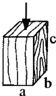
Рисунок 3.4 – Схеми навантаження зразка деревини
