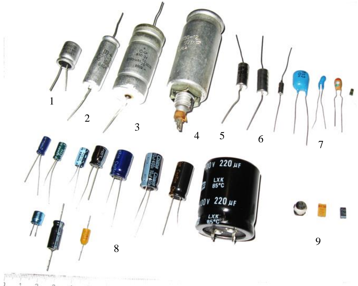
1 – К50-35; 2 – К50-29; 3 – К50-24; 4 – К50-12; 5 – К53-4; 6 – К53-14, 7 – К53-19; К53-10; 8 – іноземного виробництва; 9 – для поверхневого монтажу
