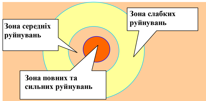
Рисунок 3.1 – зони руйнувань при вибуху паливної речовини у відкритому просторі
