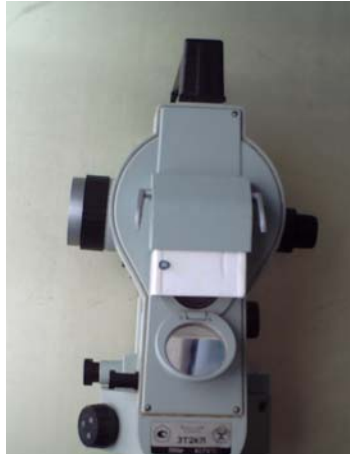
Рис. 4. Світлодіодний ліхтар у робочому положенні на теодоліті
