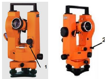
Рис. 1.7. Зовнішній вигляд теодоліту 3Т2КП: 1 – виправний гвинт циліндричного рівня; 2 – гвинт точного встановлення відліку за горизонтальним кругом.
