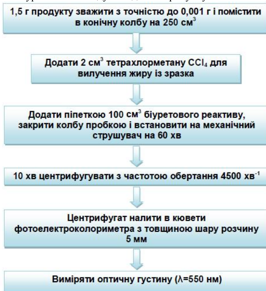
Рисунок 3.4 – Схема визначення масової частки білків біуретовим методом
