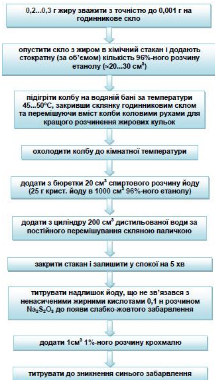
Рисунок 4.5 – Схема визначення йодного числа жиру методом Маргошеса
