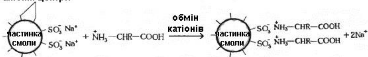
Рисунок 2.5 – Схема іонообмінної хроматографії
