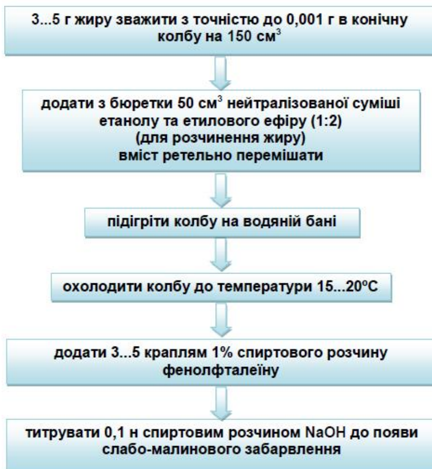
Рисунок 4.4 – Схема визначення кислотного числа харчових жирів
