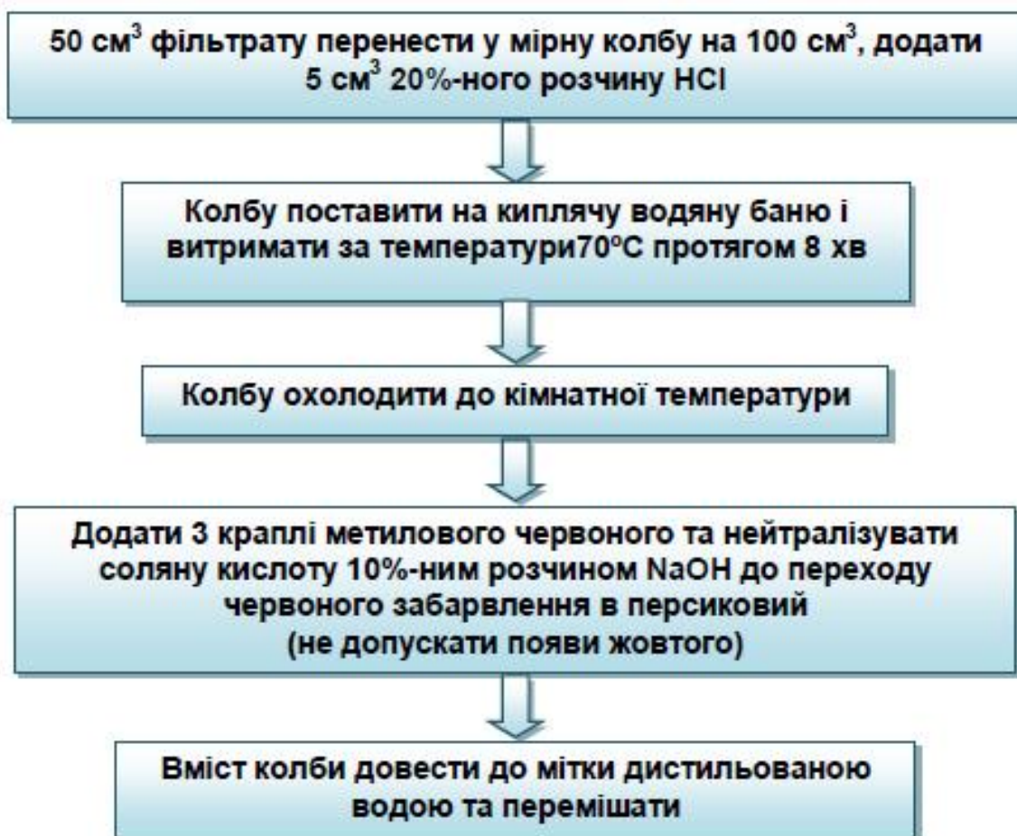
Рисунок 6.5 – Схема послідовності дій проведення гідролізу сахарози
