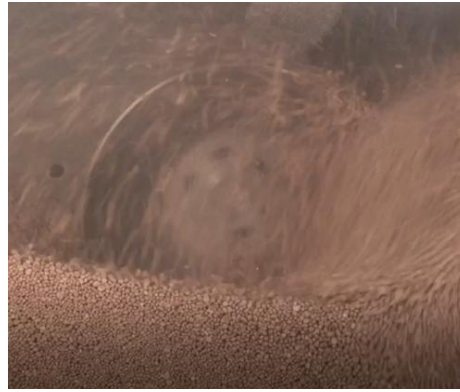
Рис. 2 – Фотофіксація руху гранул у внутрішній частині диспергатора
