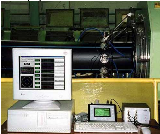
Рис. 1 – Зовнішній вигляд 8 каналної системи ультразвукової дефектоскопії і контролю
