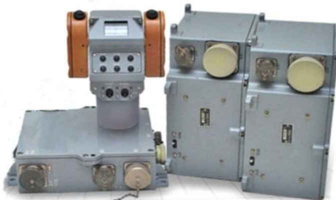
Рис. 1 – Комплекс цифрового стабілізатора озброєння СВУ-500-10Р
