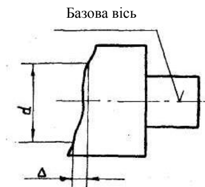
Рисунок 1.4–Схема до визначення торцевого биття
