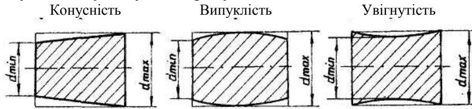
Рисунок 1.9– Окремі випадки відхилення профілю поздовжнього перетину
