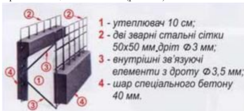
Рис. 5.16. Конструкція МДМ-панелі
