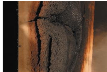
Рис. 5.8. Комплексний підхід до пожежної безпеки: а) схема протипожежного захисту; б), в) випробування плити на горючість в лабораторії; г), д) переріз панелі після 30 хвилин дії полум'я
