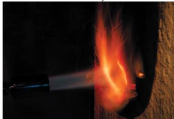
Рис. 5.8. Комплексний підхід до пожежної безпеки: а) схема протипожежного захисту; б), в) випробування плити на горючість в лабораторії; г), д) переріз панелі після 30 хвилин дії полум'я
