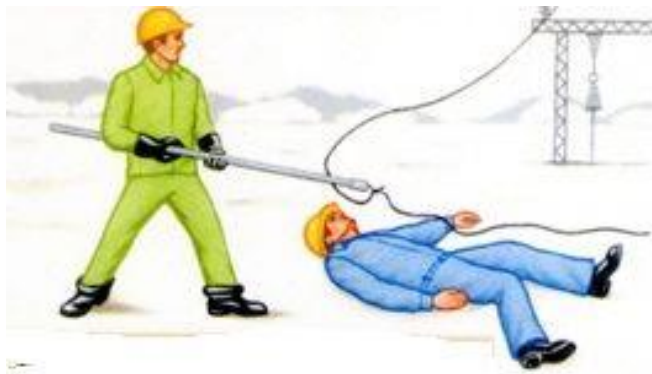
Рисунок 3.18 – Звільнення потерпілого від дії електричного струму: а – за малих наруг; б – за напруги більше 1000 В
