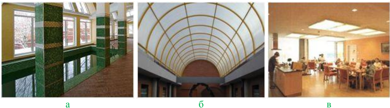
а – бокове одностороннє освітлення; б – верхнє освітлення; в – комбіноване освітлення
