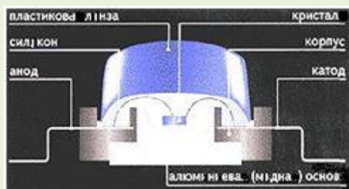
Рисунок 2.65 – Конструкція світлодіодної лампи
