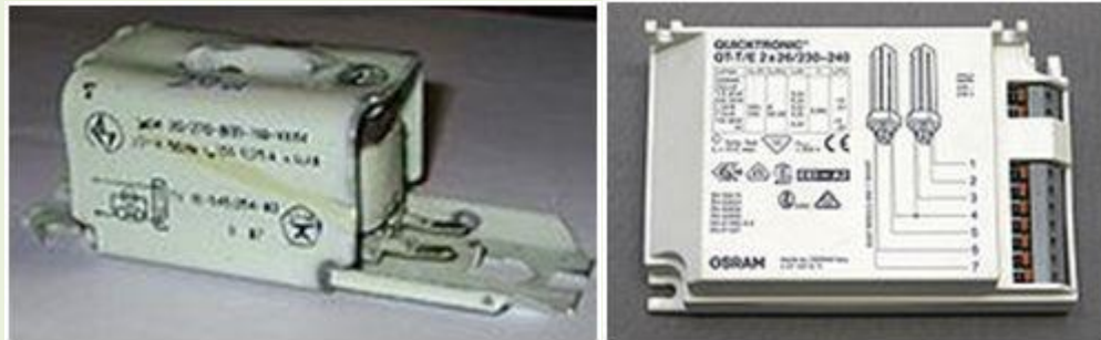
Рисунок 2.57 – Електромагнітний (а) та електронний баласт (б)
