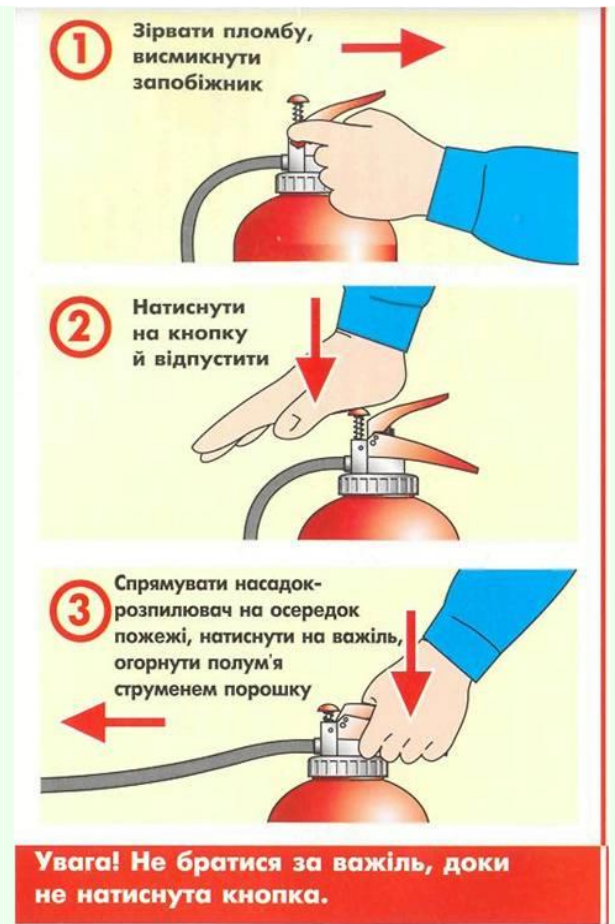
Рисунок 4.3 – Будова та спосіб приведення в дію порошкового вогнегасника
