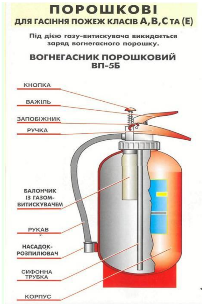
Рисунок 4.3 – Будова та спосіб приведення в дію порошкового вогнегасника
