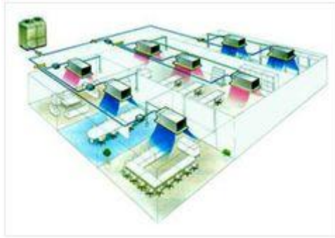
Рисунок 2.27 – Схема кондиціонера чиллер-фанкойл
