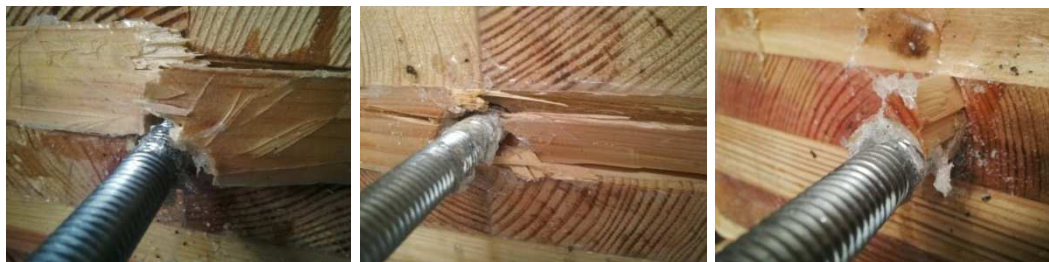
Рис. 4. Характер руйнування зразків
