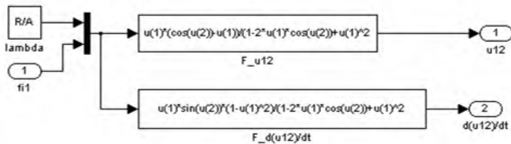
Рис. 4. Розрахункова кінематична функція мальтійського механізму з прямими пазами
