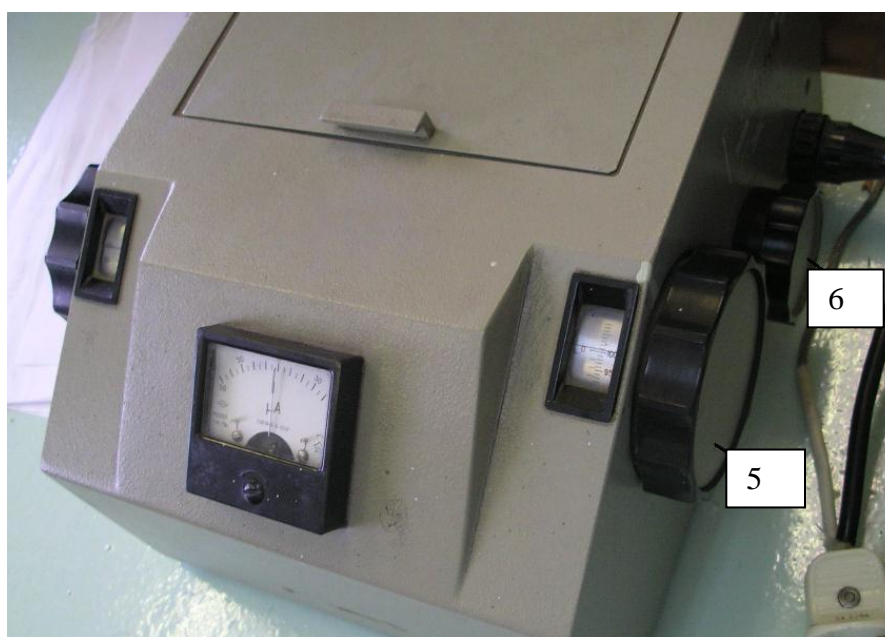
Рисунок 7.1 – Колориметр-нефелометр фотоелектричний ФЕК-56 М: 1 – вимірювальний блок; 2 – кришка; 3 – освітлювальний вузол; 4 - ручка для перекриття світлових потоків; 5 – рукоятка правої вимірювальної діафрагми; 6 – рукоятка для кріплення кювети; 7 – рукоятка лівої вимірювальної діафрагми; 8 – рукоятка перемикача світлофільтрів; 9 – рукоятка налаштування нуля.
