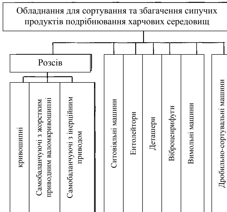
Рисунок 81 – Класифікація обладнання для сортування та збагачення сипучих продуктів подрібнювання харчових середовищ
