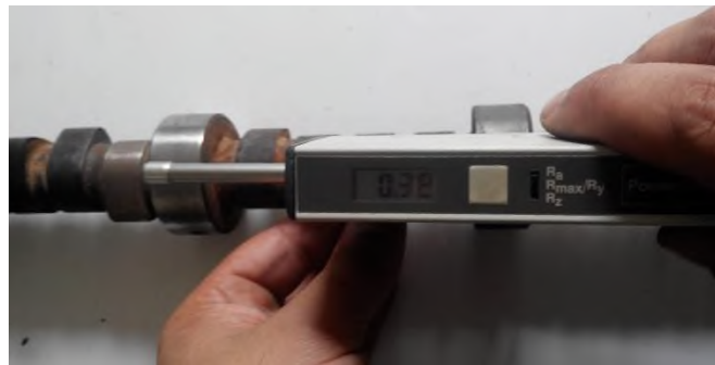
Рис. 12. Вимірювання шорсткості обробленої поверхні деталі
