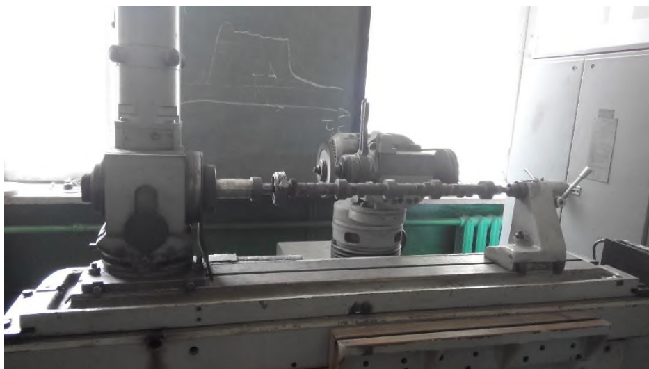
Рис. 4. Процес фрезерування розподільчого вала
