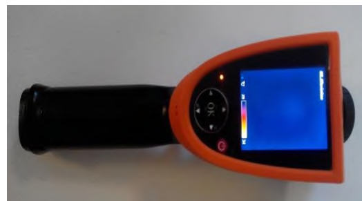
Рис. 10. Тепловізор моделі ULIRVISION TI-384
