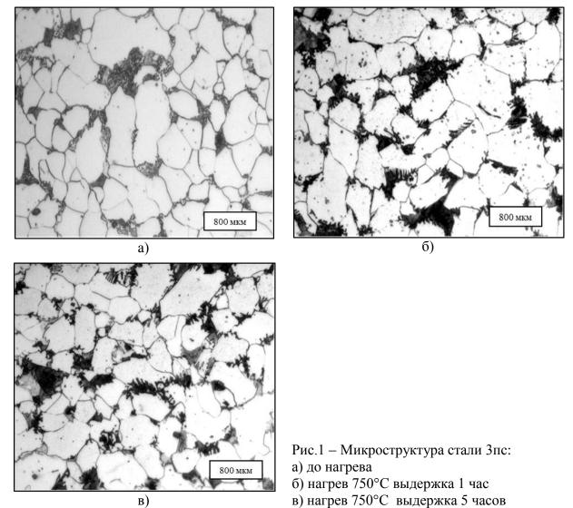
Таким образом термообработка низколегированных и низкоуглеродистых сталей в двухфазной области, при надкритическом температурном воздействии 750°С приводит к снижению твердости, прочностных и магнитных свойств сталей. Такая зависимость позволяет контролировать структуру металла в ответственных объектах металлургии: грузоподъемные краны и другие объекты транспортирующий жидкий металл.
