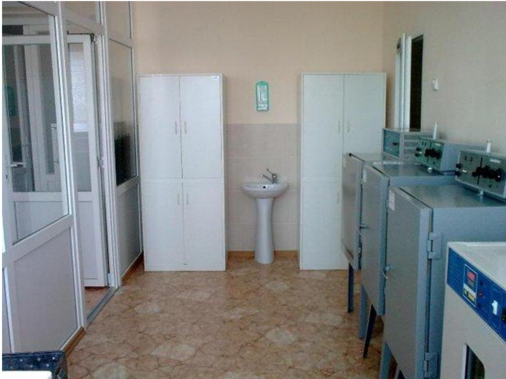
Рисунок 1.5 – Передбоксік (оснащений термостатами на різну температуру, шафами для середовищ і стерильного одягу для роботи в боксі, стаціонарними бактерицидними лампами – стельовими та настінними)
