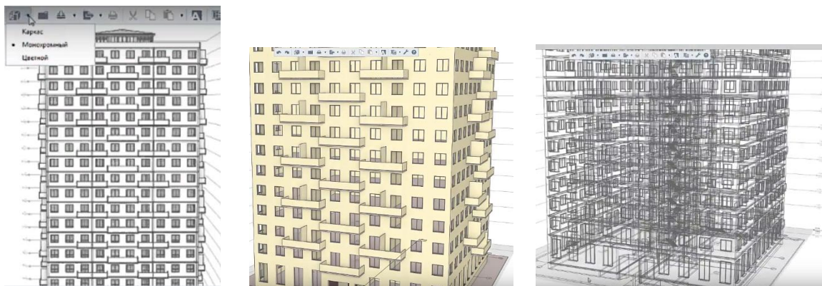
Рисунок 1.10 – Монохромний, кольоровий та каркасний стилі відображення моделі
