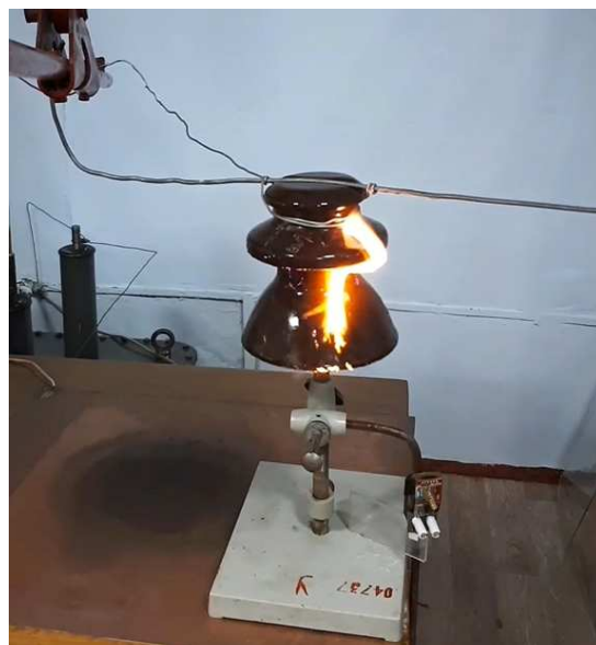
Рисунок 13 – Фото пробою ізолятора під час лабораторного дослідження з пристроєм
