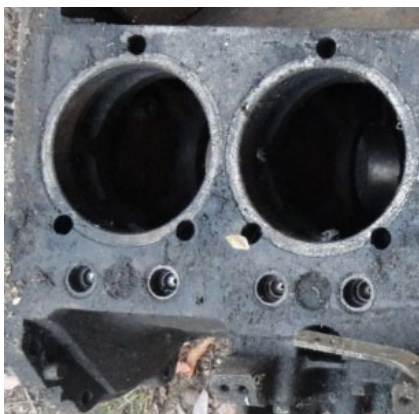
Рисунок 1 - Місце встановлення болта кріплення в картер двигуна
