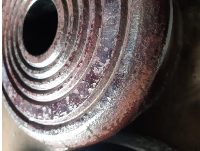
Рис. 4 – Зовнішній вигляд робочої поверхні наплавленої пресової шайби після 40 пресувань трубної заготовки зі сплаву МНЖ-5-1
