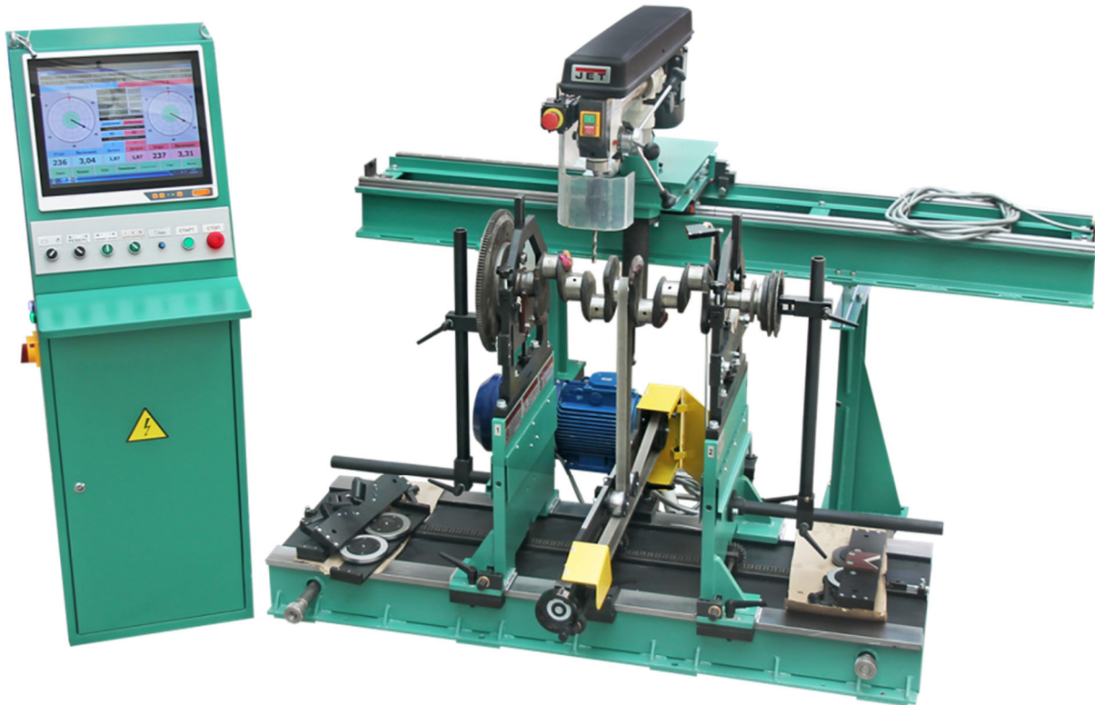
Рисунок 2 – Верстат моделі 9Д715УС для балансування колінчастих валів
