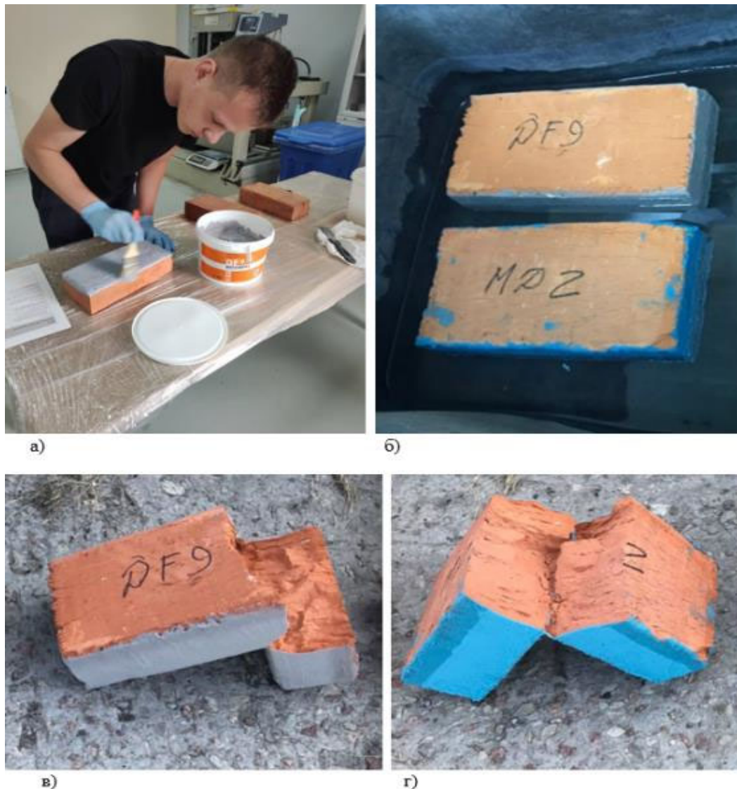
Рисунок 1. Дослідження мастик фірми MC-Bauchemie: DF 9 та MD 2 The Blue 1: а) нанесення мастик на дослідні зразки цегли; б) дослідні зразки у воді; в) вигляд зруйнованого зразку обробленого мастикою DF 9 після 24 годин перебування у воді; г) вигляд зруйнованого зразку обробленого мастикою MD 2 The Blue 1 після 24 годин перебування у воді
