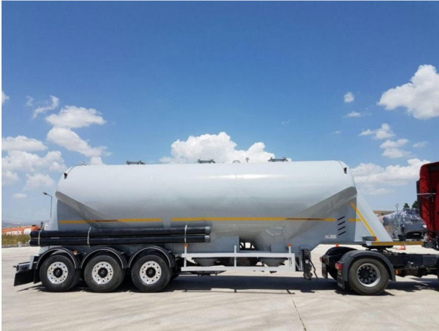
Рис.2. Борошновоз з сучасною гравітаційною системою розвантажування
