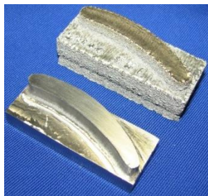
Рис. 2 – Лопатка газотурбінного двигуна створена 3D друком
