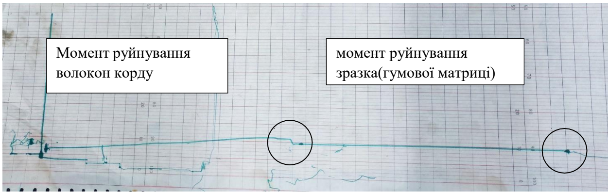
Рис. 3 – Крива деформації при розриві резинової матриці разом з волокнами металевого корду
