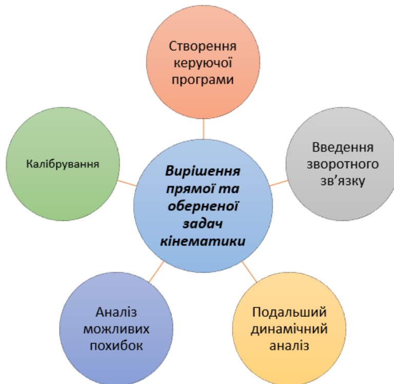
Рис. 2 – Операції, пов'язані з кінематичним аналізом при проектуванні 3D-принтера
