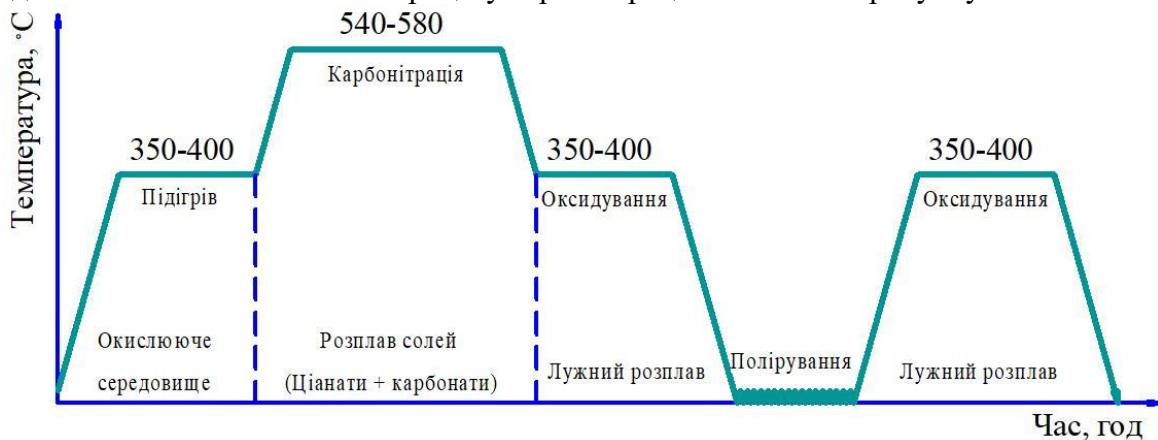
Рис. 1 – Технологічна схема процесу карбонітрації
