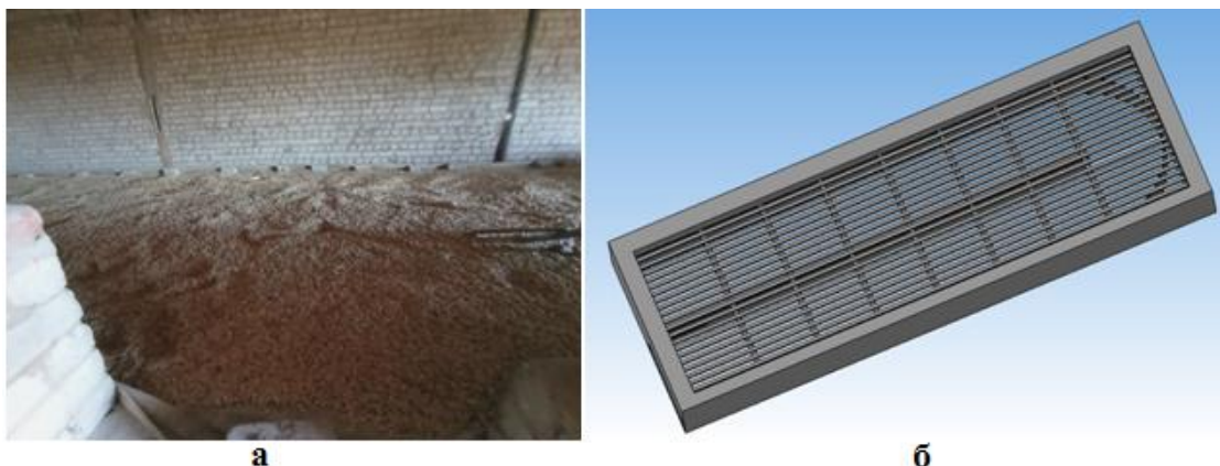
Рис. 2 – Фото сушильного столу з насінням в натурі (а) та 3D-зображення його конструкції (б)
