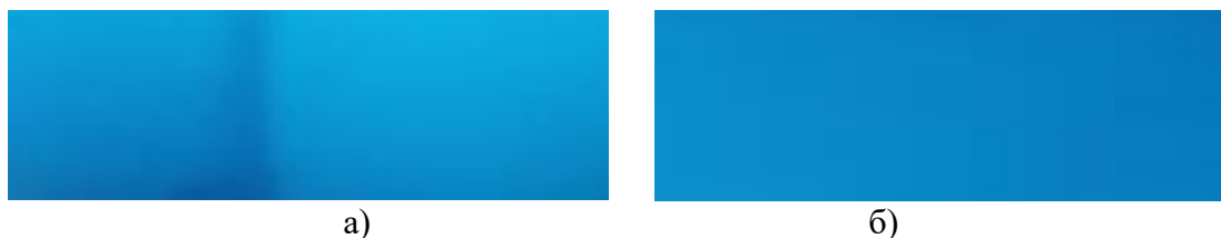
Рис. 2 – Фото труби виготовленої з ПВХ-композиції з додаванням стабілізатора а) Kimstab EPS 2100-22 FC та б) Baeropan MC 91424 FP/1.
