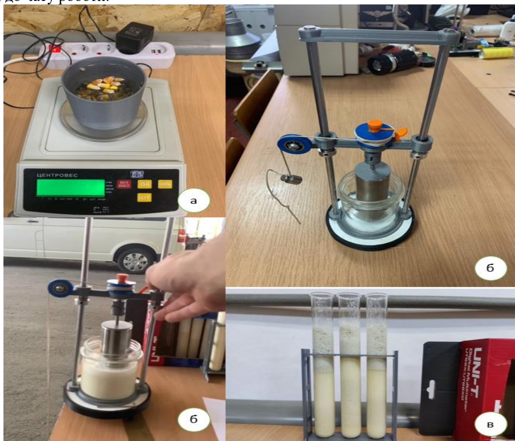
а – визначення щільності суміші; б – визначення динамічної в'язкості суміші; в – визначення частки осаду при двогодинному відстоюванні;
