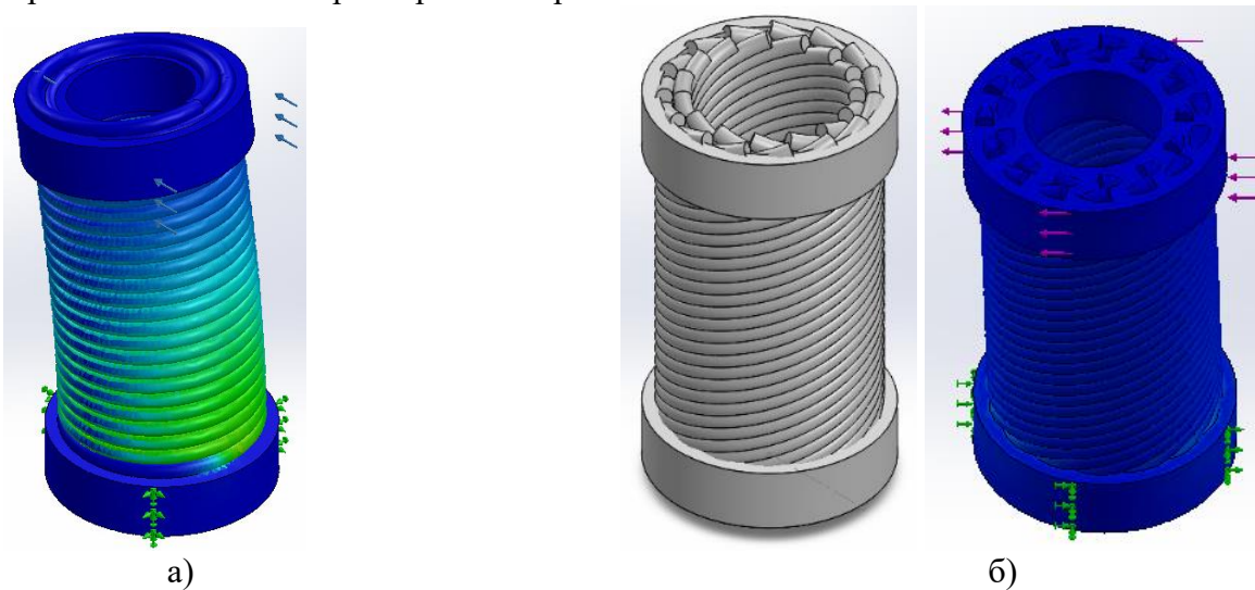
Рис.2 – Результати дослідження навантаження конструктивних елементів деталі надрукованої з плоских шарів а) та надрукованої з просторових шарів б)
