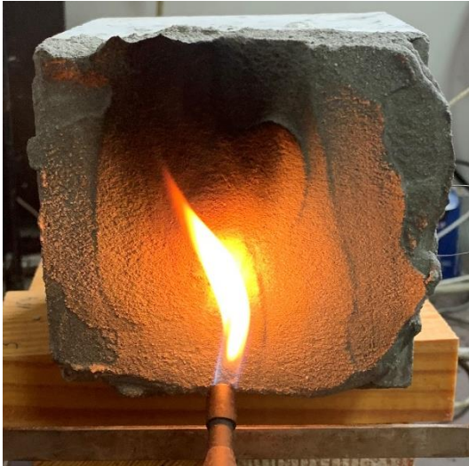
Рис. 3 – Визначення ефективності вогнезахисту бетону
