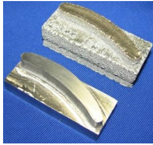
Рис. 2 – Лопатка газотурбінного двигуна створена 3D друком
