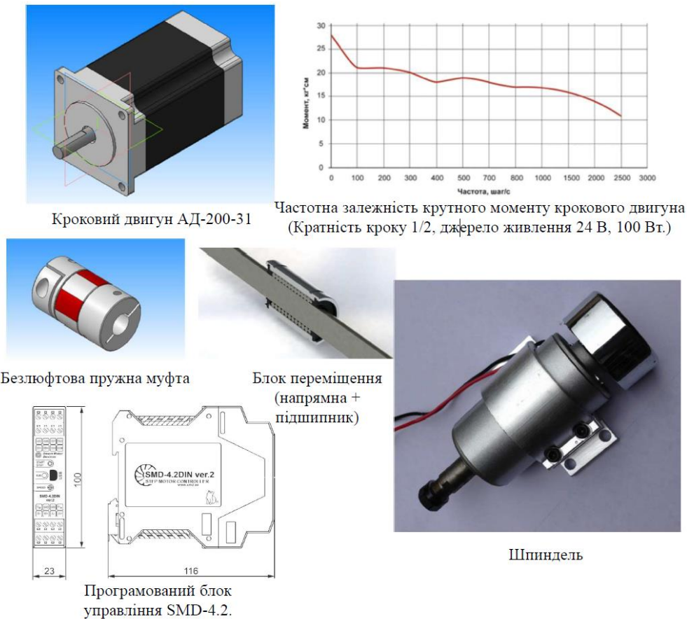
Рис. 2 – Основні вузли проектованого малого вертикально-фрезерного верстата з ЧПУ.
