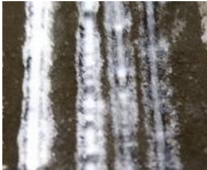
Рис. 2 – Загальний вигляд дослідного зразку. Режими наплавлення: P=240 Вт, v = 0,04-0,2 м/хв., d_0=1 мм.
