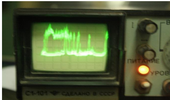
Рис. 1 – Осцилограма струму технологічних імпульсів
