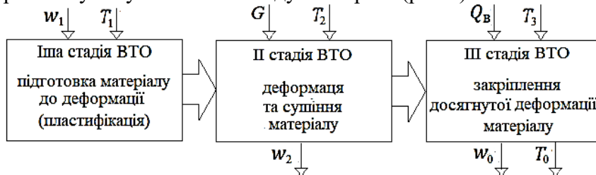
Рис. 1 – Схема стадійності процесу волого-теплової обробки трьома робочими середовищами: T_1, T_2, T_3 – значення температури робочих середовищ на I, II і III стадіях циклу; w_1, w_2 – вологовміст пластифікуючого та для сушіння робочих середовищ; w_0, T_0 – вологовміст і температура матеріалу після ВТО; G – величина механічного зусилля пресування
