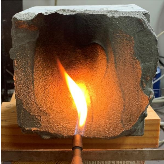
Рис. 3 – Визначення ефективності вогнезахисту бетону
