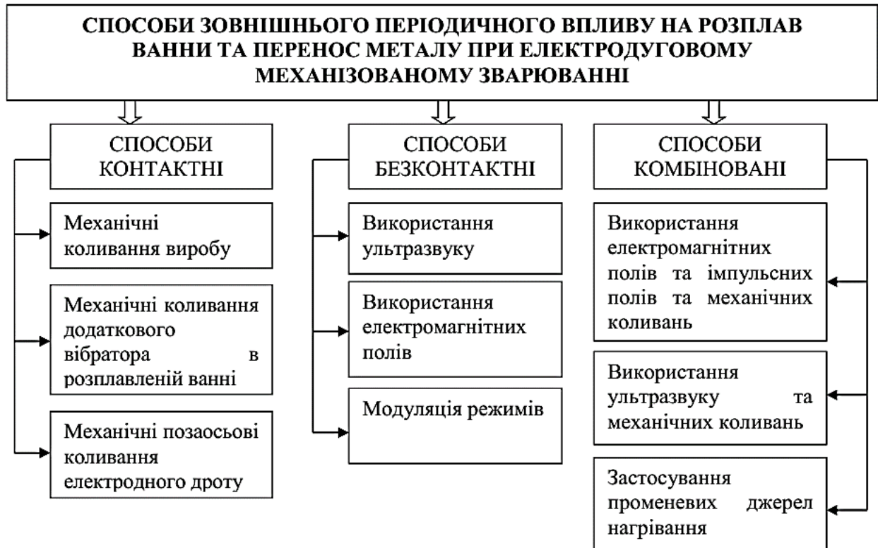
Рис.1 – Способи зовнішнього періодичного впливу на розплав ванни та перенос металу при електродуговому механізованому зварюванні
