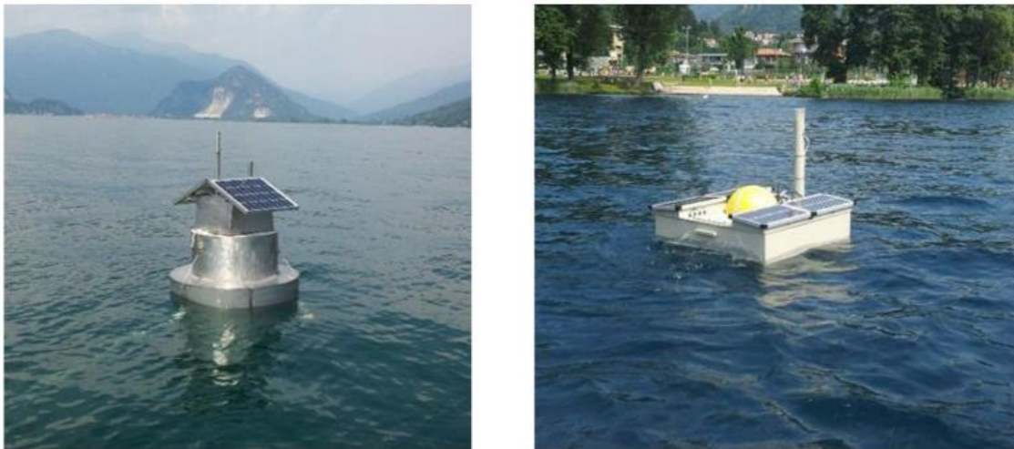
Рис. 3.2. Лімнологічні буї: а – стаціонарний буй; б – мобільний буй
