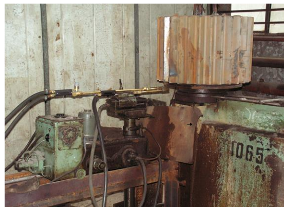
Рисунок 2 – Машинне гартування зубів шестерні модулем 25
