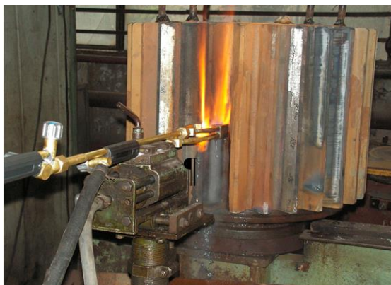
Рисунок 2 – Машинне гартування зубів шестерні модулем 25
