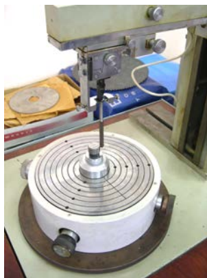
Рисунок 5.12 – Загальний вигляд а) вимірювання круглограми еталонного зразка та визначення глибини западини б) h_{ет} засобами MathCAD
