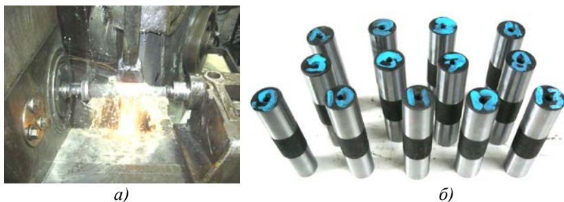
Рисунок 3.3 – Процес обробки а) заготовки врізним шліфуванням та загальний вигляд б) дослідної партії зразків-виробів
