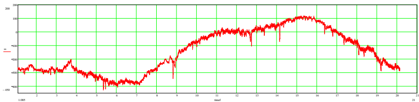
Рисунок 5.11 – Відхилення ординати контуру опорної поверхні втулки в перерізі №2 після видалення западин
