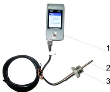
Рисунок 2.30 – Загальний вид цифрового вимірювача температури: 1 – цифровий вимірювач температури, 2 – термоелемент, 3 – штуцер
