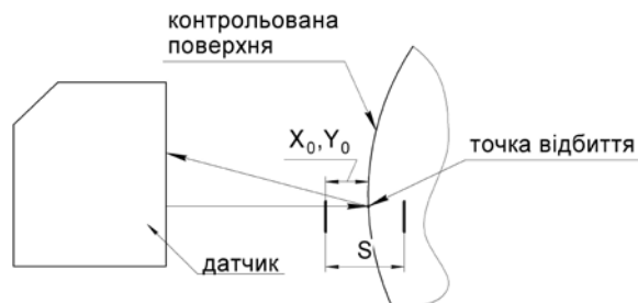
Рисунок 2.32 – Схема визначення початкового положення точки відбиття лазерного променя
