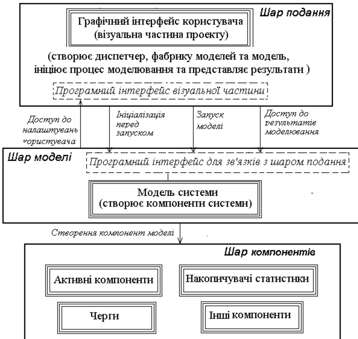
Рисунок 3.4 - Структура застосування для моделювання СМО
