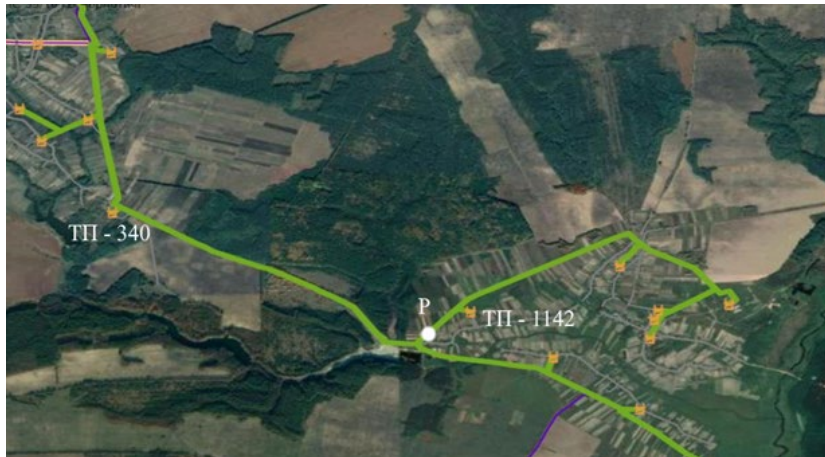
Рис.2 - Топологія розміщення реклоузера в електричній мережі 10 кВ
