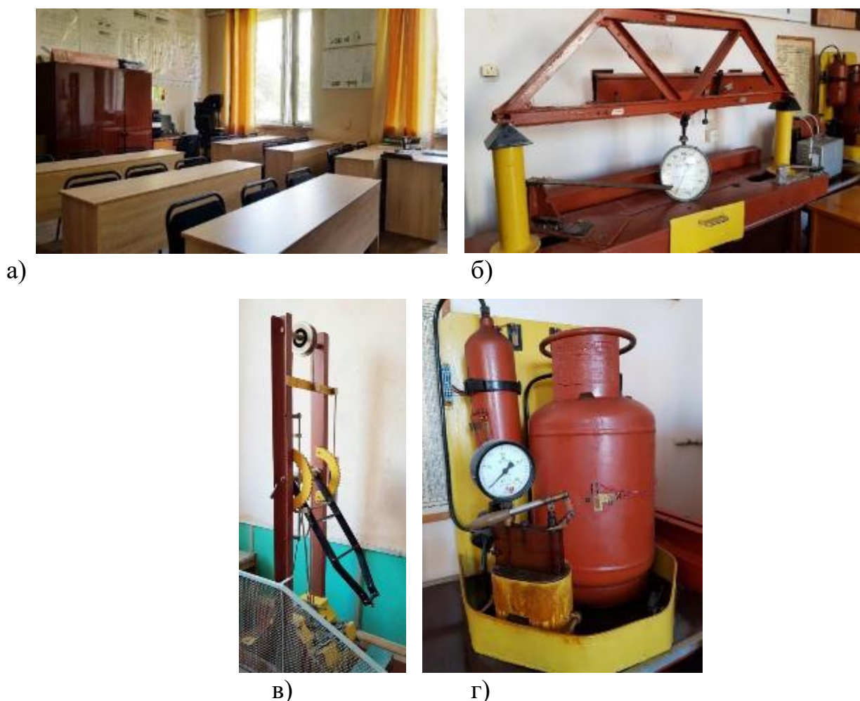
Рисунок 1.7 – Лабораторія напружень та деформацій: а) загальний вид лабораторії; б) лабораторний стенд для дослідження напружень та деформацій у вузлах балок та ферм; в) маятниковий копер; г) лабораторний стенд
