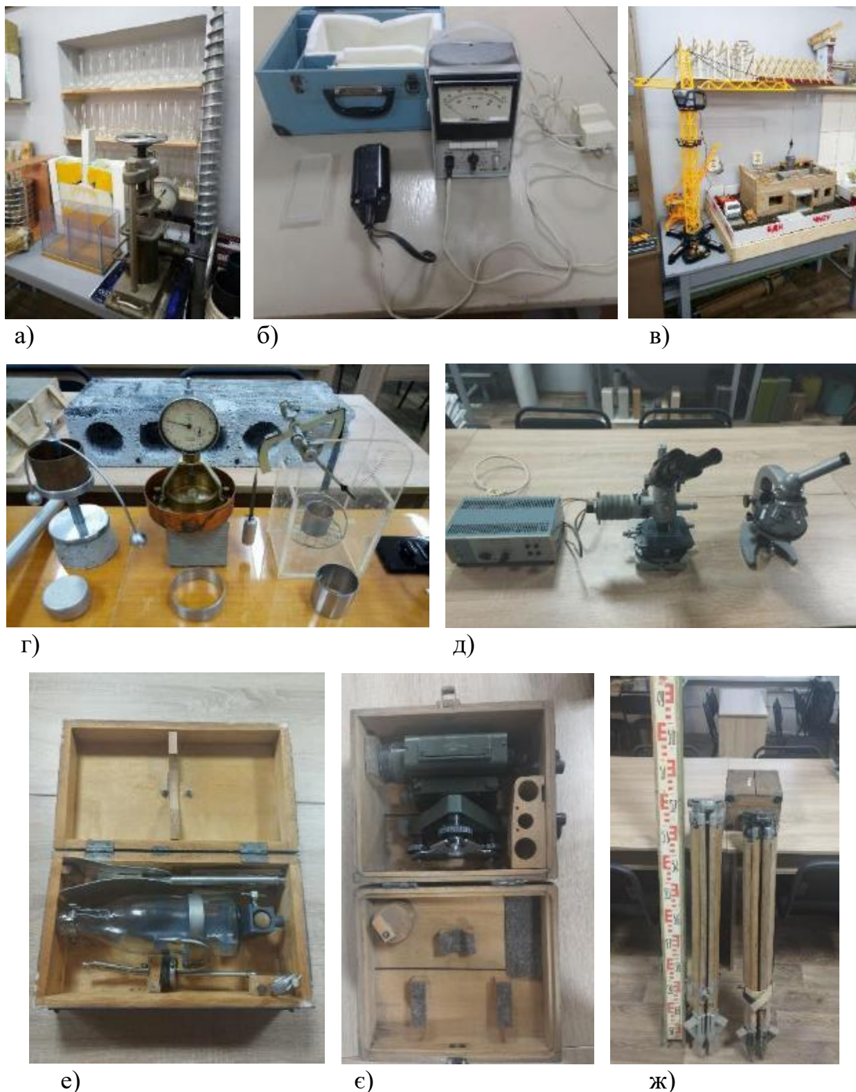
Рисунок 1.4 – Обладнання лабораторії «Механіки ґрунтів, геотехніки та фундаментобудування»: а) прес гідравлічний з манометром типу ПГЛ-5; б) вимірювач захисного шару ИЗС-10Н; в) макет будівельного майданчику; г) конус Васильєва, прилад визначення набухання ґрунтів – ПНГ, прилад розмокання ґрунту – ПРГ; д) мікроскопи ММУ-3 та МБР-1; е) батометр-пляшка ГР-16М; е) нівелір НВ-1; ж) рейка та штативи до нівеліру
