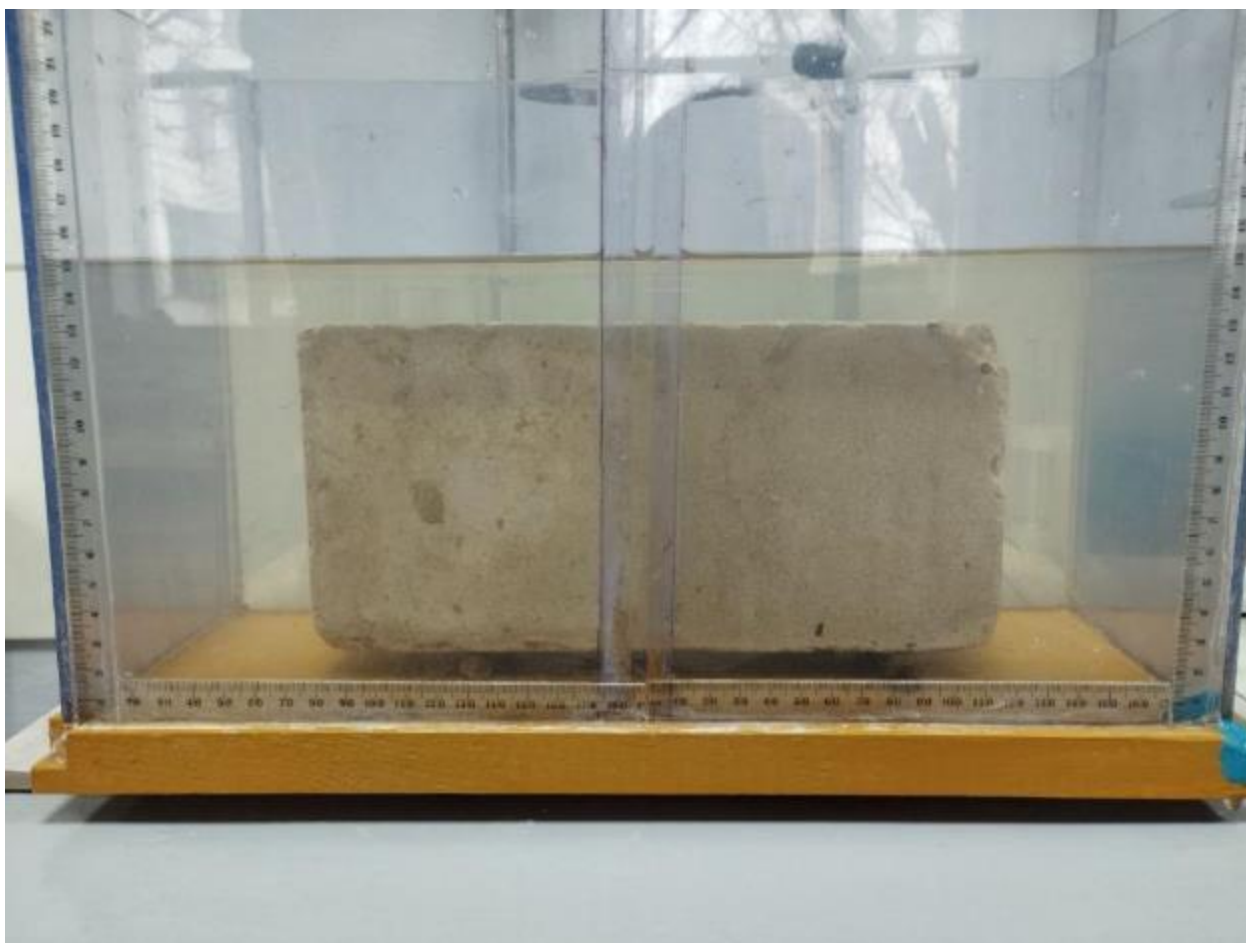
Рисунок 5.2 – Насичення водою цегли силікатної в ванночці
