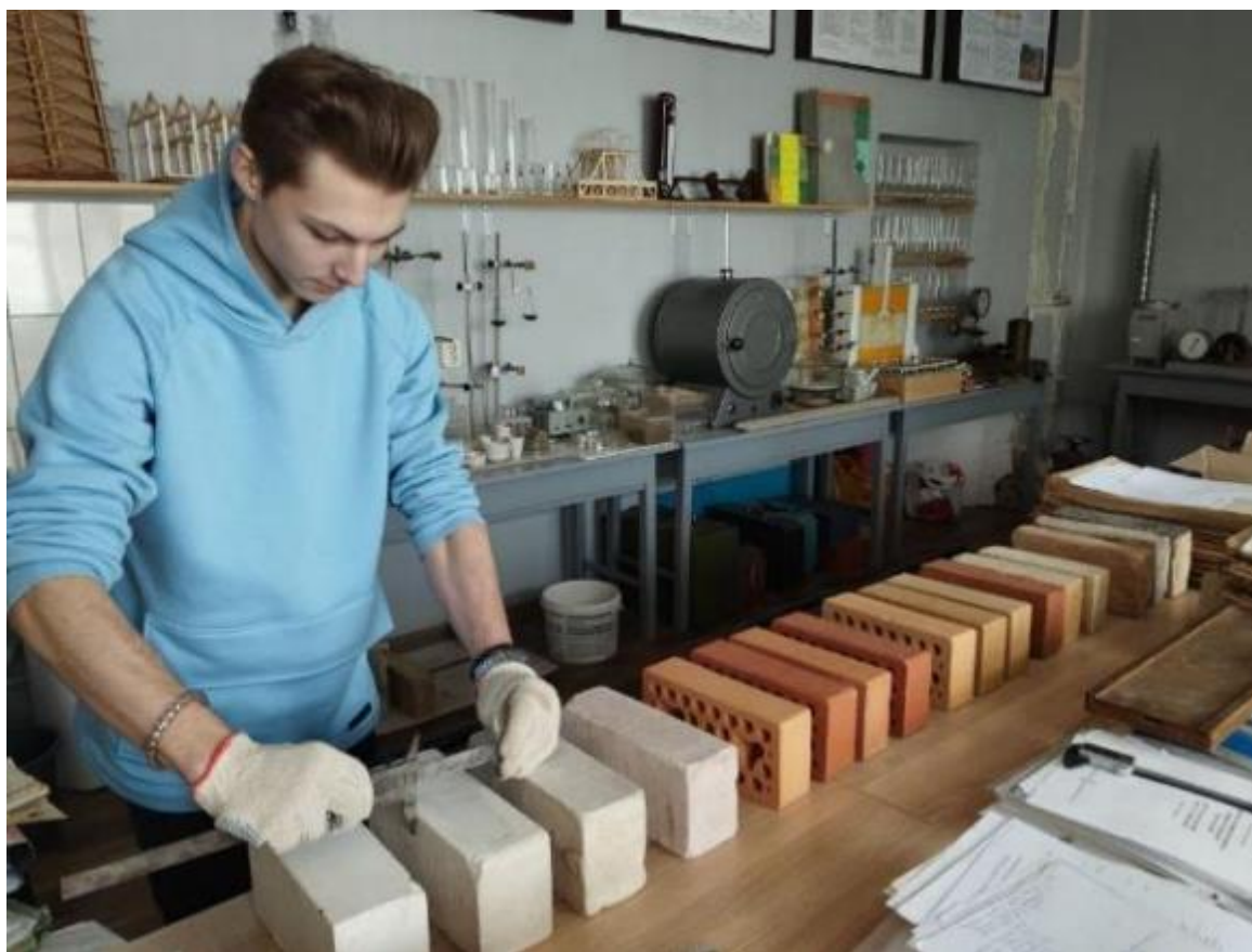
Рисунок 5.1 – Встановлення геометричних розмірів цегли
