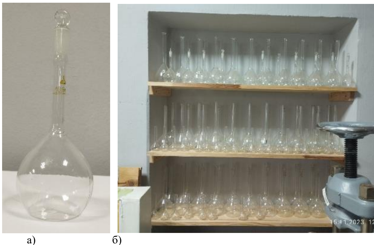
Рисунок 1.15 – Пікнометри: а) загальний вид; б) пікнометри та колби в лабораторії
