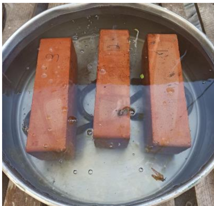
Рисунок 5.3 – Насичення водою цегли глиняної в ванночці
