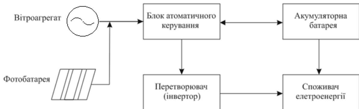
Рис. 3. Блок-схема типової комплексної системи електропостачання з відновлюваними джерелами енергії
