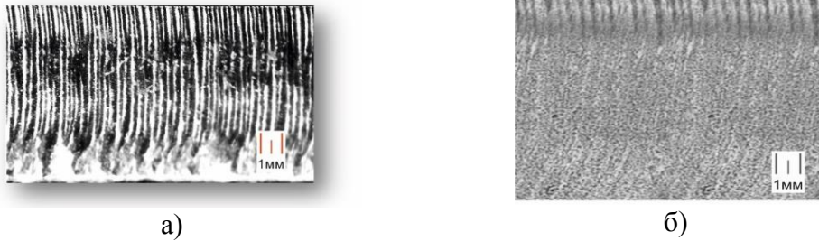
Рис. 2 – Вигляд поверхні різку після ГЛР а) та після кулькового вигладжування б).
