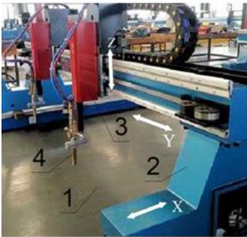
Рис. 1 – Компонівка машини термічного різання (а) та гістограма розподілу та крива нормального розподілу похибки позиціонування по осі X (б)
