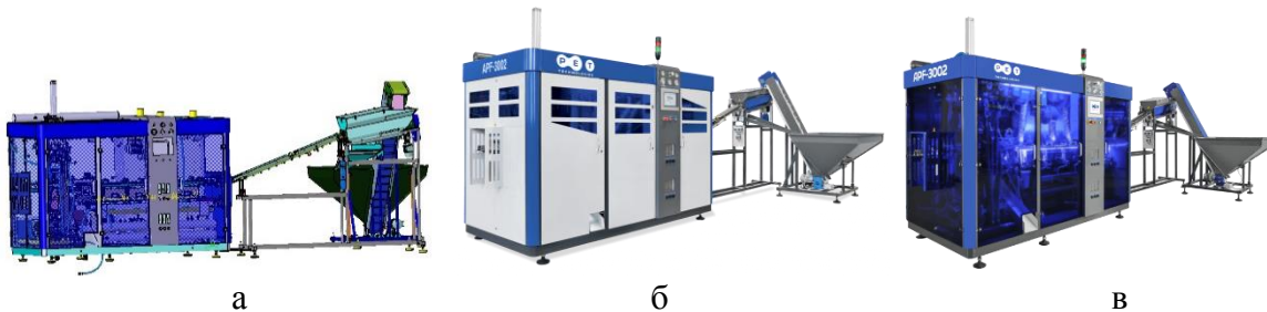
Рис. 3 – Етапи розробки та вдосконалення дизайну видувної машини моделі АПФ3002 ТОВ «ПЕТ Технолоджиз»: а – тривимірна модель; б – дизайн першого покоління; в – дизайн останнього покоління
