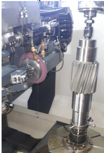
Рис. 1 – Установка шліфувального круга з рубін-корунду на верстаті
