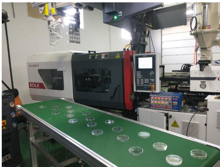
Рис. 1 Процес виготовлення виробу «Чашка Петрі».
