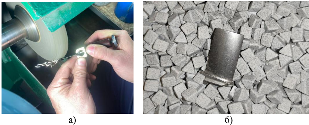
Рис.1 – Полірування профіля лопатки, яке виконується вручну (а) і в середовищі абразивного наповнювача (б).
