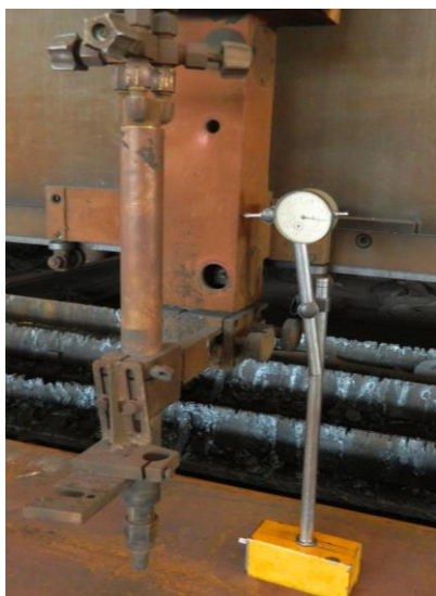
Рис. 2 – Вимірювання похибки позиціонування
