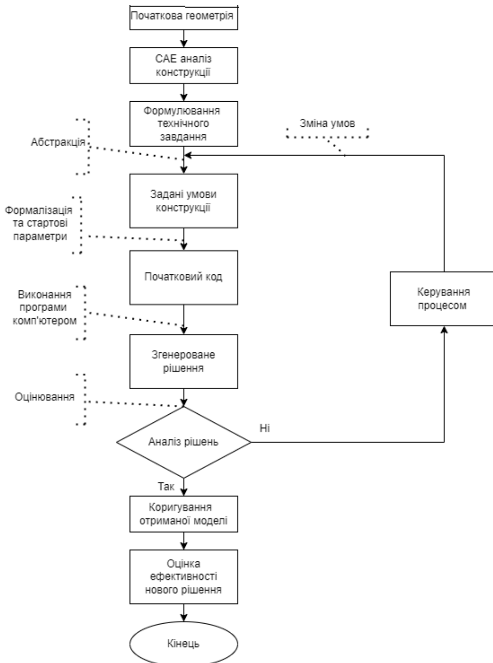
Рис. 2 – Алгоритм методу вдосконалення конструкцій на основі генеративного дизайну
