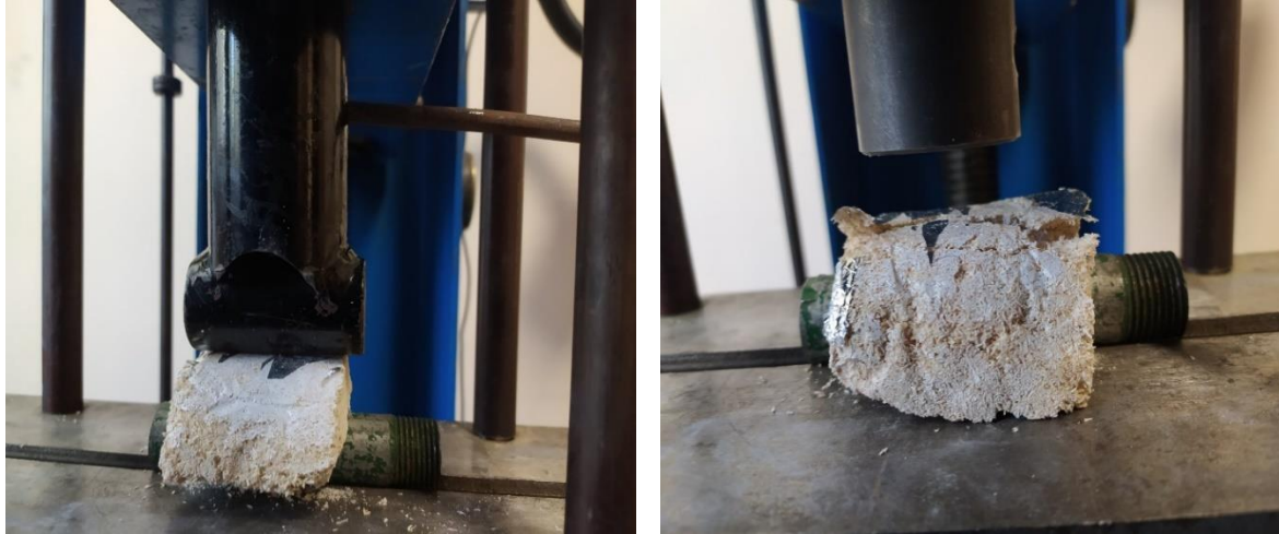
Рис. 2 – Дослідження на міцність теплоізоляційних виробів з деревини
