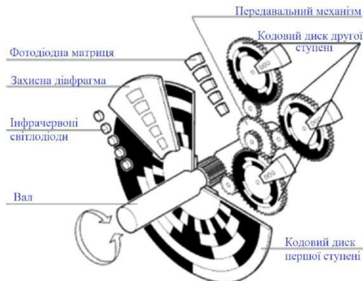
Рисунок 1.6 – Внутрішня будова багатообертового еncодера
