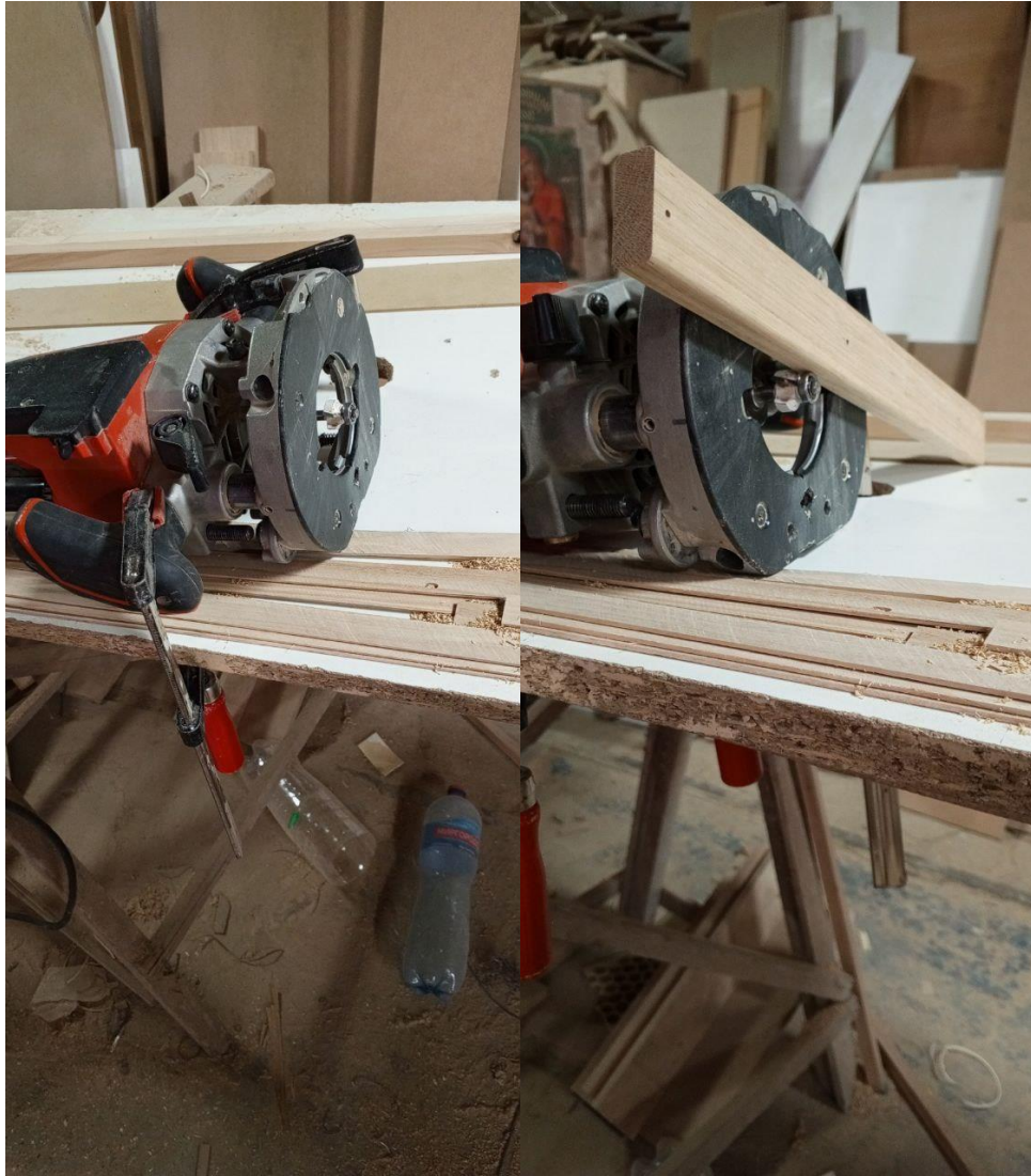
Рисунок 2.6 – Обробка ручним фрезером
