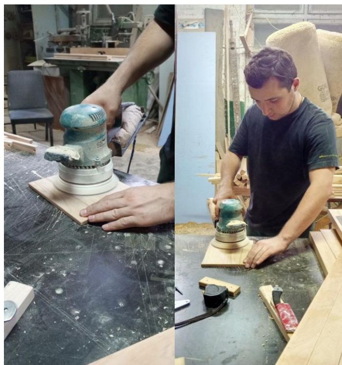
Рисунок 2.11 – Шліфуємо кришку після клеєння.
