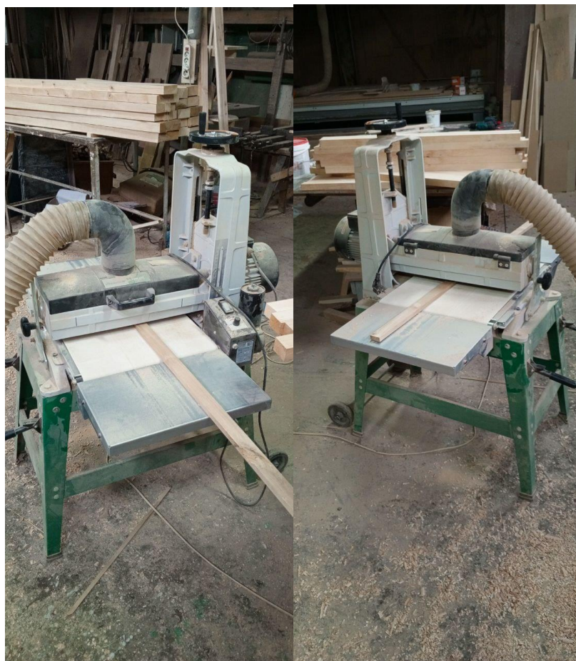
Рисунок 2.4 – Обробка на барабанно-шліфувальному верстаті
