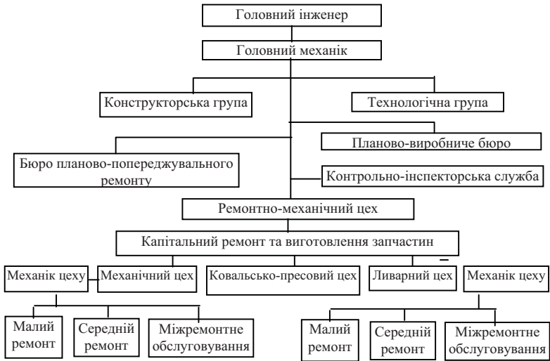
Рис. 7.3. Структура ремонтного господарства машинобудівного заводу (змішана система)
