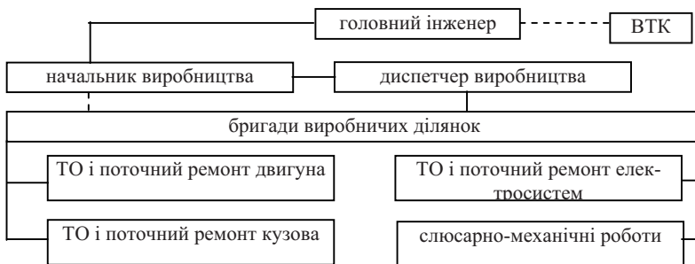
Рис. 5.5. Структура виробництва при формуванні бригад при агрегатно-дільничній формі організації робіт
