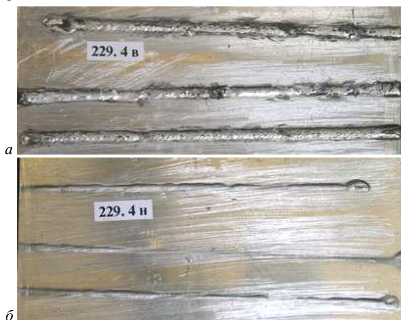
Рис. 3. Наплавочные швы на сплаве АМгб толщиной 2,0 мм, выполненные с подачей присадочной проволоки Св-АМгб (Ø1,2 мм) гибридным лазерно-плазменным способом: а – вид сверху; б – вид снизу
