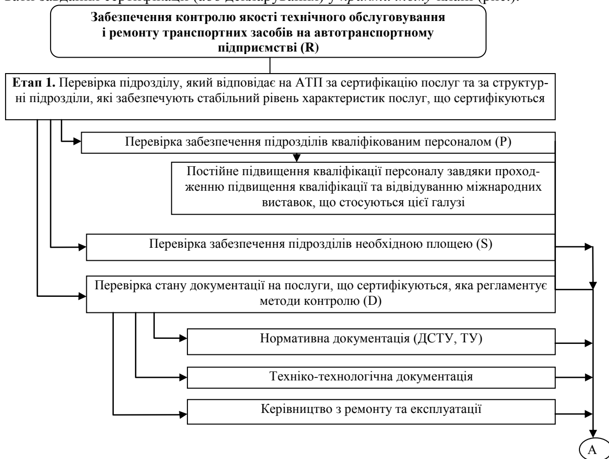
Рис. Функціональна схема процесу моніторингу показників якості технічного обслуговування та ремонту автомобілів
