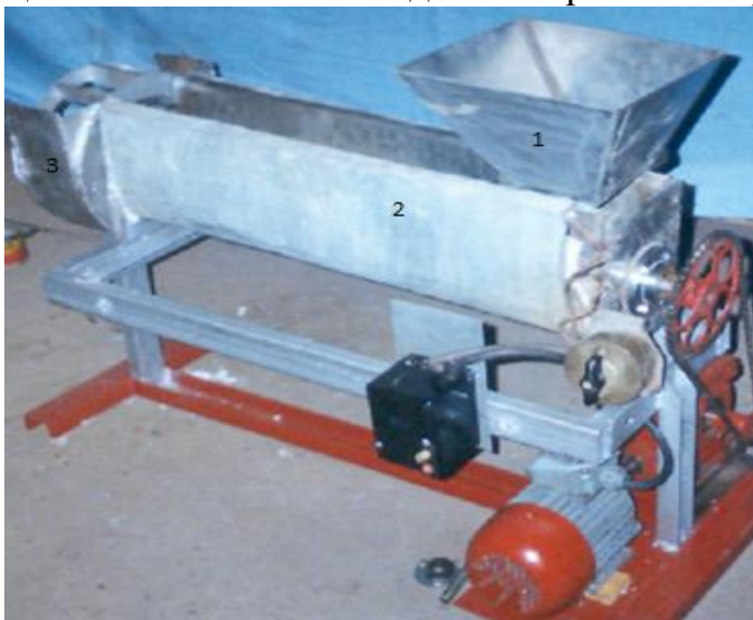
Рисунок. Аппарат для термической обработки зерна различных культур во фритюре.
