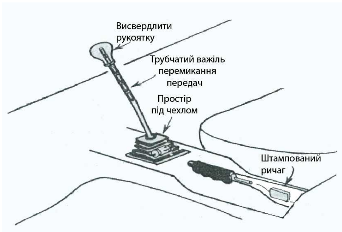
Мал. 43. Тайник у важелях передач та ручного гальма
