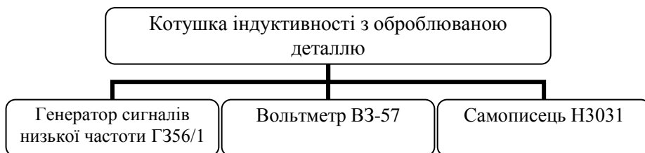
Рис. 1 Принципова модульна електрична схема індуктивного перетворювача
