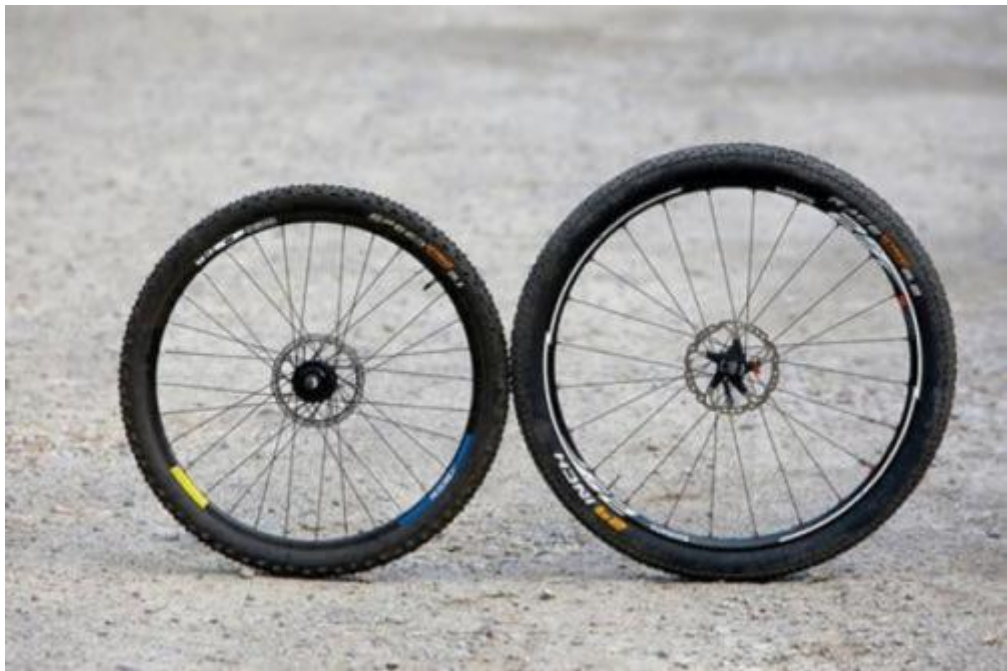
Рисунок 2.15 Велосипедні колеса: 26 дюймів (1) та 28 дюймів (2)
