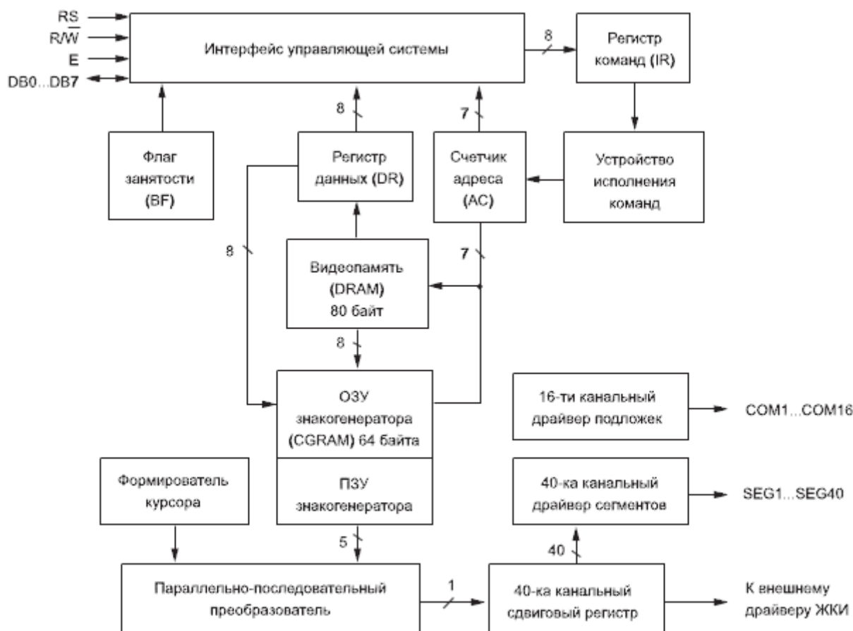
Рисунок 1.2 – Упрощённая внутренняя структура ЖКИ-модуля
